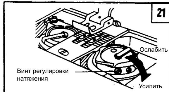
б. Если натяжение игольной нитки слишком мало, а шпульной, наоборот, велико, то наблюдается картина, показанная на рис. 20, п. "С". В этом случае поверните винт регулировки натяжения по часовой стрелке для увеличения натяжения или поверните шпулевочный винт для уменьшения степени натяжения шпулевочной нитки (см. рис. 21 и 22).
