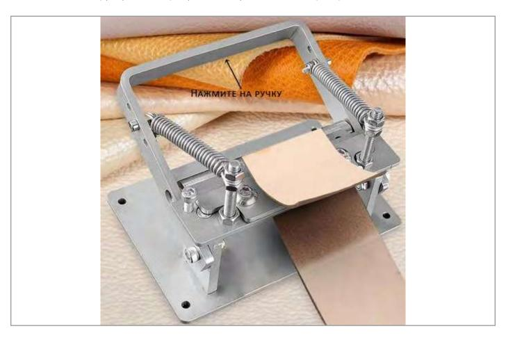
4. Толщина регулируется: На обоих концах машины есть регулировочные винты для регулировки толщины двоения. Максимальная ширина полоски кожи составляет 8 см
