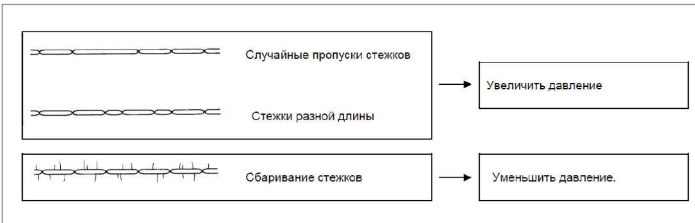
Давление лапки по возможности должно быть минимальным, но достаточным, чтобы избежать проскальзывания подачи материала. (См. ниже о положении регулировочного винта).
