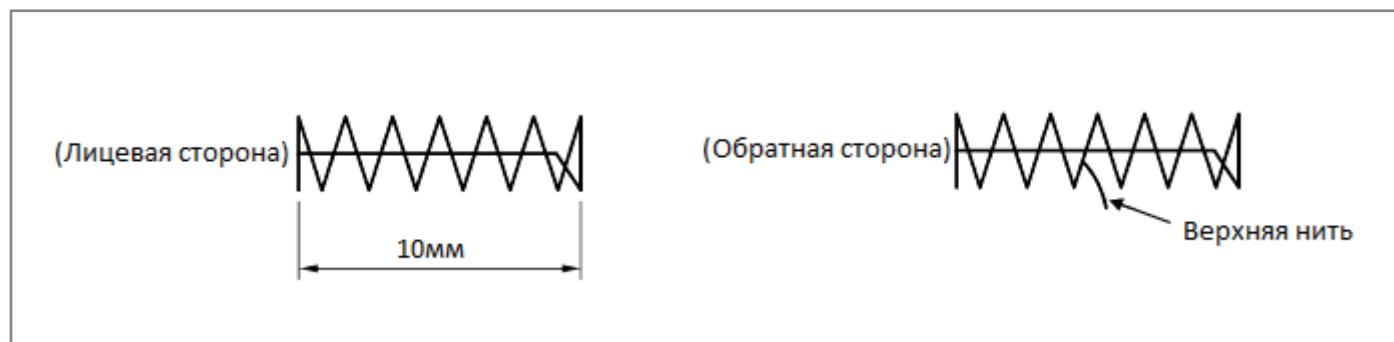
5. На машине модели A-40, нижняя нить, при некоторых типах материала и нити, может торчать с обратной стороны материала на втором стежке. В таких случаях рекомендуется использовать программы шитья, для которых предусмотрено применение устройства зажима нити.
