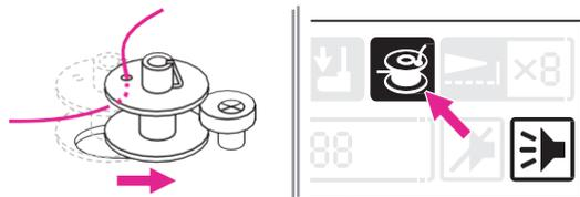
5. Сдвиньте шпindel с установленной на нем шпулькой вправо для активирования режима намотки шпульки. На дислее отобразится соответствующая иконка.
