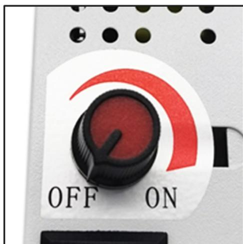
Это ручка (см. рисунок выше) отвечает за регулировки температуры: установите нужную температуру в зависимости от материала. Примерно через 30 секунд, после установки температуры нагревания, устройство готово к использованию.
