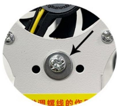
Перед заменой лезвия ослабьте средний винт, поворачивая его против часовой стрелки (см. рисунок выше), а затем открутите 4-е крепёжных винта лезвия.
