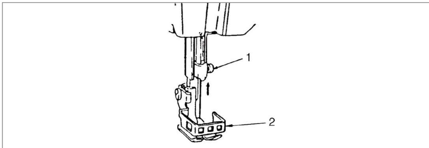
Поверните маховик, до тех пор, пока игловодитель не примет верхнее положение, затем ослабьте винт 1, вставьте иглу в игловодитель до упора.
