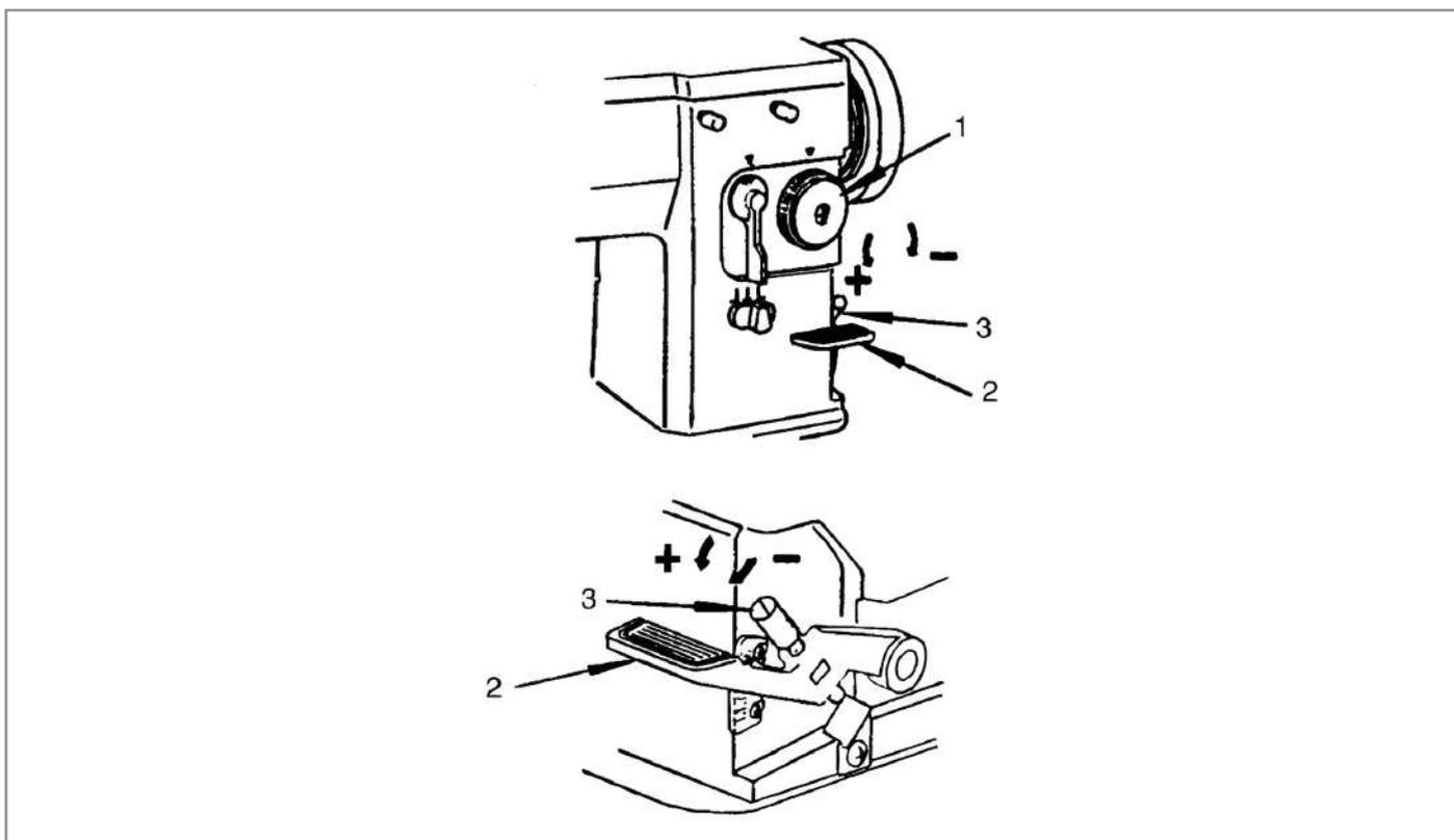
Поверните ручку-регулятор длины стежка (1) в направлении стрелки и установите нужную длину стежка:
