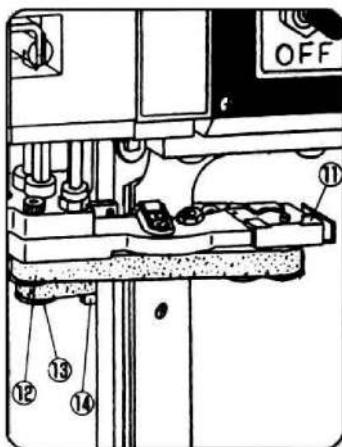
1. Нажмите фиксатор (11) и снимите ремень (12) (рис. 5).
