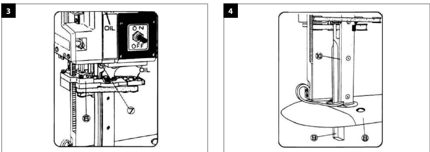
1. Переведите переключатель в положение «off» («выкл.») (2) (рис. 2) после того, как подъемник заточного устройства (6) (рис. 3) займет крайнее верхнее положение.
