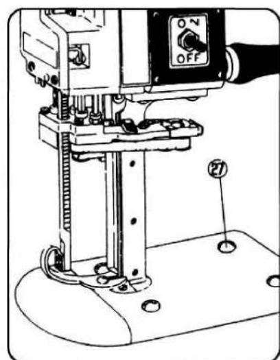
1. Чистите мотор и заточное устройство с помощью сжатого воздуха не реже одного раза в неделю.
