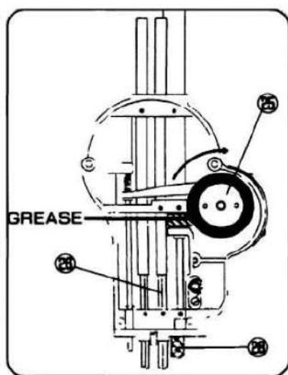
1. Резиновый шкив (25) (рис.9) не будет приводиться в действие, если на нем осталась смазка. Очистите остатки смазки хлопчатобумажной тканью.
