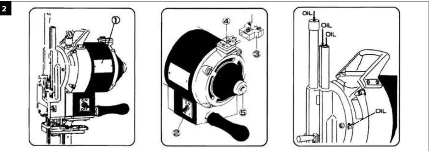
1. (Прежде чем начать работу, проверьте, находится ли устройство заточки в крайнем верхнем положении. (Способ регулировки положения подъемника заточного устройства см. далее в настоящем руководстве по эксплуатации).
