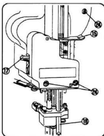
1. Переместите рычаг заточки (15) (рис. 6) в промежуточное положение, подъемник (6) (рис. 3) при этом должен свободно перемещаться.
