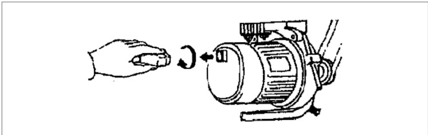
После запуска машины посмотрите на сферический индикатор потока масла и убедитесь, что масло течет, значит масляная система в порядке. Затем дайте машине поработать вхолостую в течении 15 минут, начиная с малой скорости с ее постепенным возрастанием.
