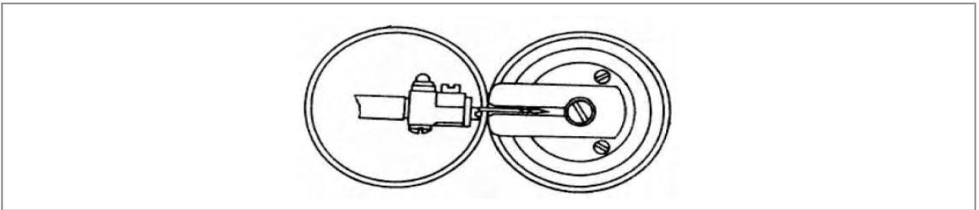
Зазор между иглой и диском подачи составляет 0,1-0,15мм
